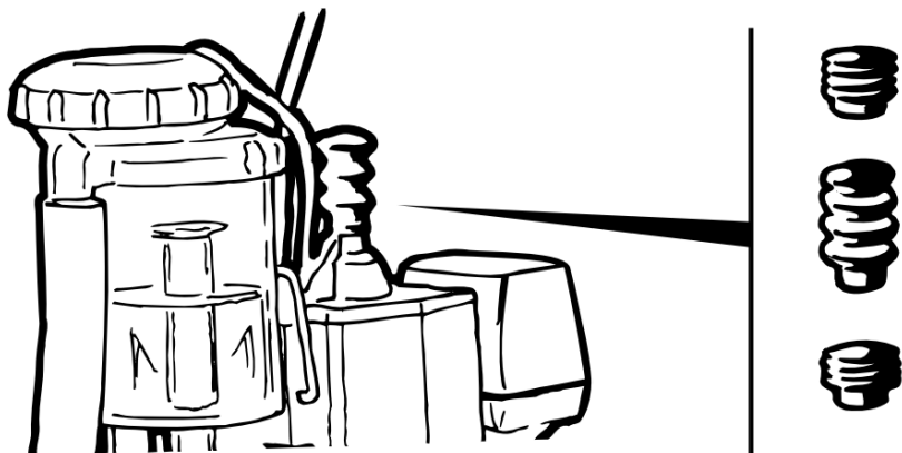
Рисунок 8 – Сильфон (сигнальные меха) Дуовак
